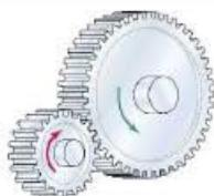
شکل رو برو دو چرخ دنده با تعداد دنده های متفاوت را نشان می دهد. وقتی بر یکی از آن ها نیروی محرک وارد شود، کدام یک تندتر می چرخد؟ دلیل خود را توضیح دهید.
